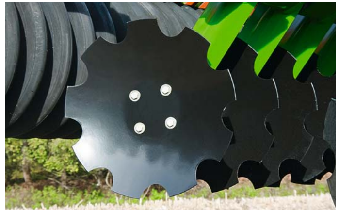
Discos Catros+: 5 mm de espesor de material, 51 cm de diámetro
